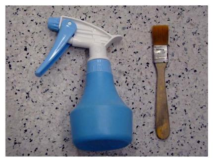
噴槍與軟毛刷:噴槍裡面裝的是顯像液,軟毛刷是用來在顯像時幫助反應用的。 顯像液也需要調配,我自己的使用方法是,先將顯像液調配好(※1:20 的比例),然後拿一個大的保特 瓶裝起來,因爲顯像液會與空氣反應而失效,之後再將一部分的顯像液溶液倒入噴槍,其餘放置陰 暗處存放(需蓋緊蓋子)。這樣做的目的是爲了節省顯像液的使用。說明書上將溶液調配好之後放在塑 膠盆即可顯像,但這樣一來蝕刻液接觸空氣面積大,隔天那些顯像液可能就無法反應了,另外用噴的也 可以將較細部的電路顯像出來,這是我的經驗提供大家參考。
